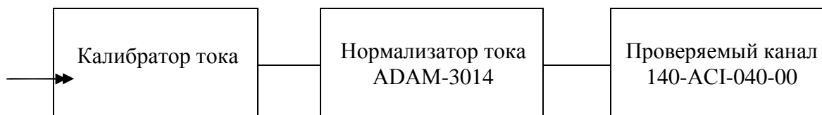
Рисунок 1.1 – Схема измерительная для каналов типа 1
